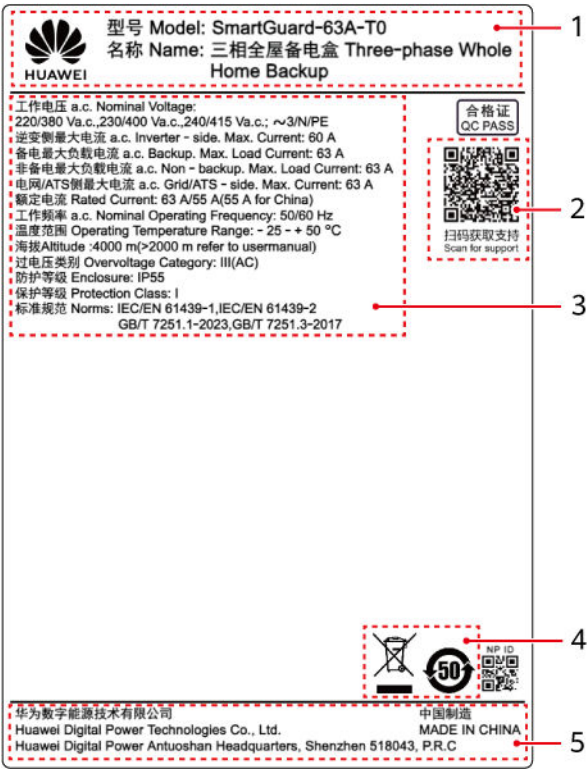
Figura 2-13 Plăcuță de identificare (de exemplu SmartGuard-63A-T0)
